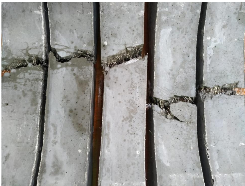
Figura 4.6-Microfissuras nos provetes ensaiados no ensaio de tração direta uniaxial.
