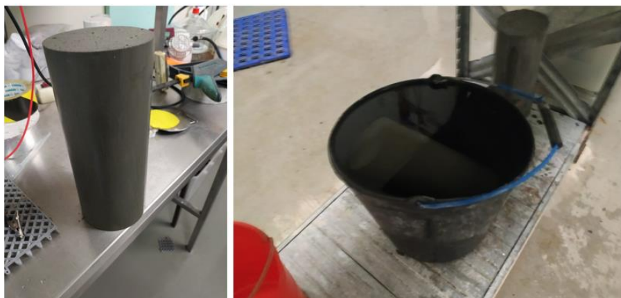
Figura 3.21- Provete utilizado no ensaio da resistividade elétrica superficial (imagem da esquerda), provete foi mantido dentro de água (imagem da direita).
