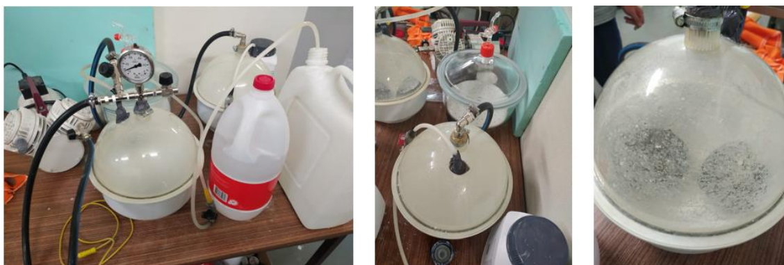
Figura 3.26-Amostras para o ensaio de penetração de cloretos sujeitas à câmara de vácuo.
