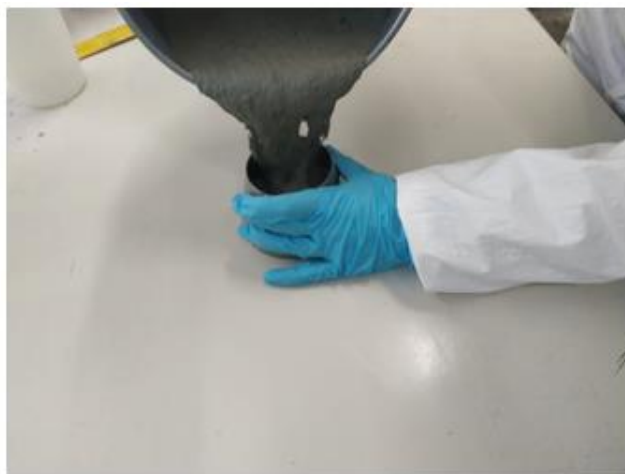
Figura 3.5- Ensaio de espalhamento para uma mistura com 2% de fibras.
