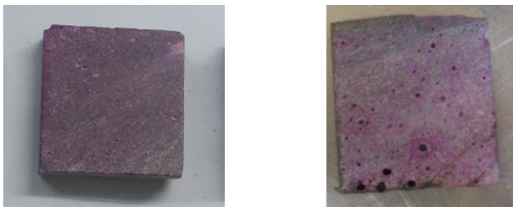
Figura 5.7- Provetes ensaiados após 12 e 3 meses na câmara de carbonatação acelerada, respetivamente, UHPFRC-A (figura da esquerda) e UHPFRC-B (figura da direita)
