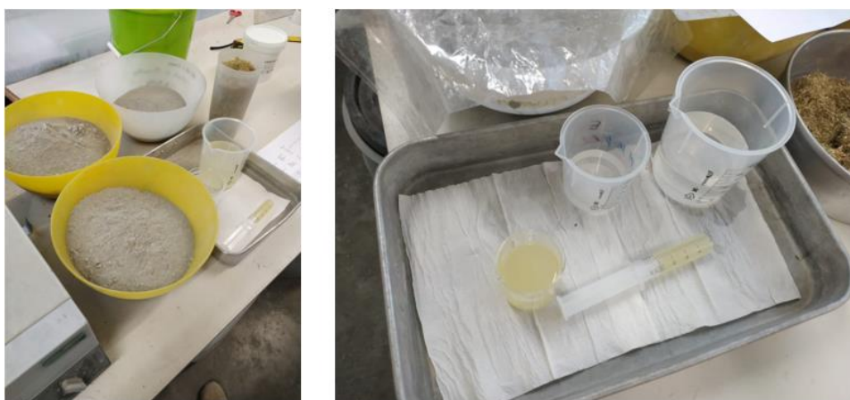
Figura 3.3- Materiais constituintes da mistura de UHPFRC
