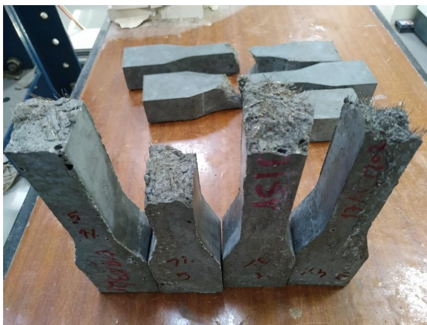
Figura 4.7-Provetes com diferentes dosagens de fibras já ensaiados à tração direta uniaxial
