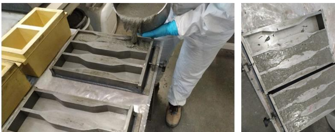
Figura 3.9- Preparação dos provetes “Dog Bone”
