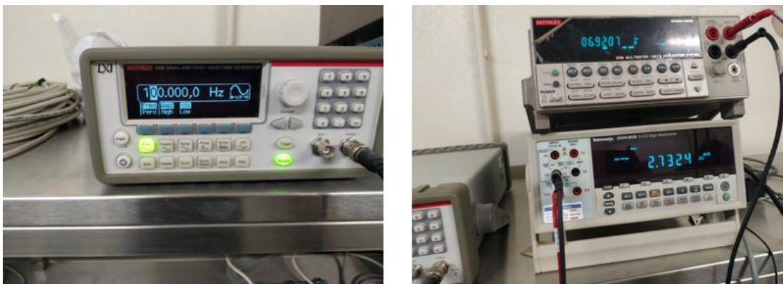
Figura 3.22-Equipamentos usados no ensaio da resistividade elétrica. Gerador de sinal (imagem da esquerda), Voltímetro e Amperímetro (imagem da direita).
