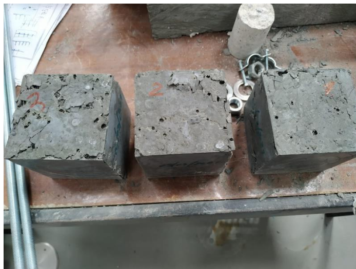
Figura 4.3-Provetes após o ensaio à compressão
