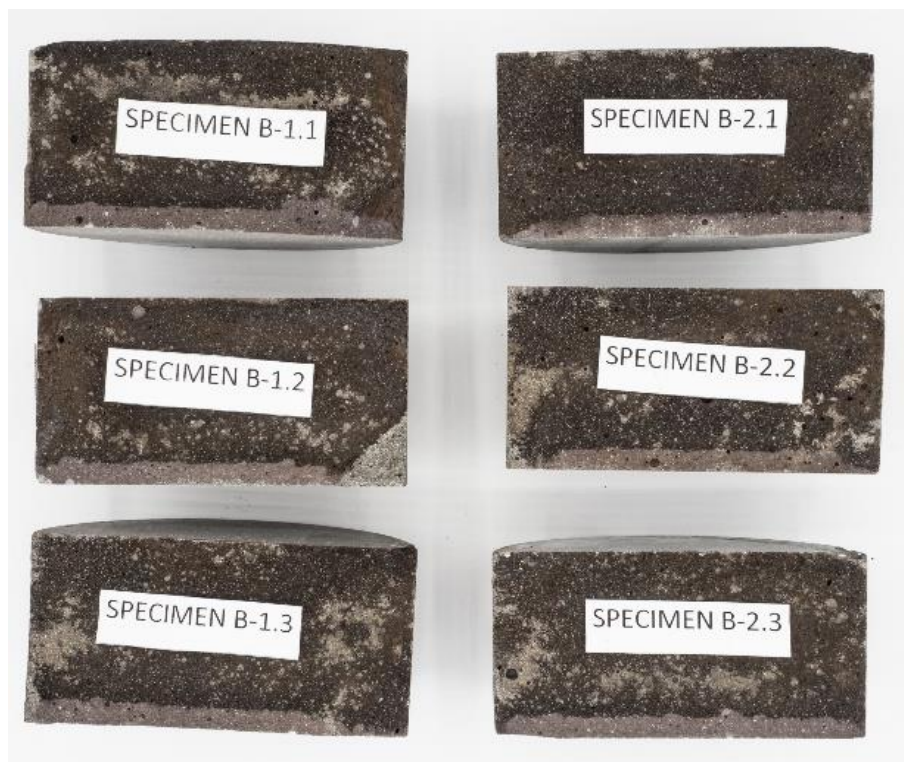
Figura 5.6- Amostras após o ensaio da penetração rápida de cloretos aos 28 dias (UHPFRC-A).
