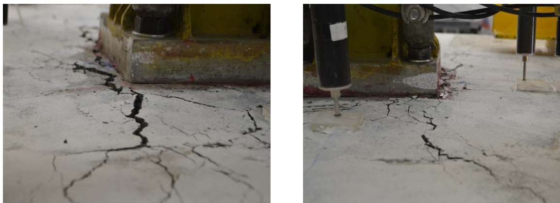
Figura 9. Fotos de fendilhação junto ao pilar, para os modelos C-HP600-L (esquerda) e C-HP600-M (direita), durante deslocamentos relativos respectivamente de 5,5% e 6,0%
