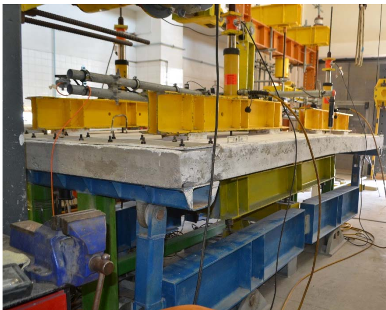
Figura 8. Modelo C-HP600-L durante o ciclo de 3% de deslocamento relativo
