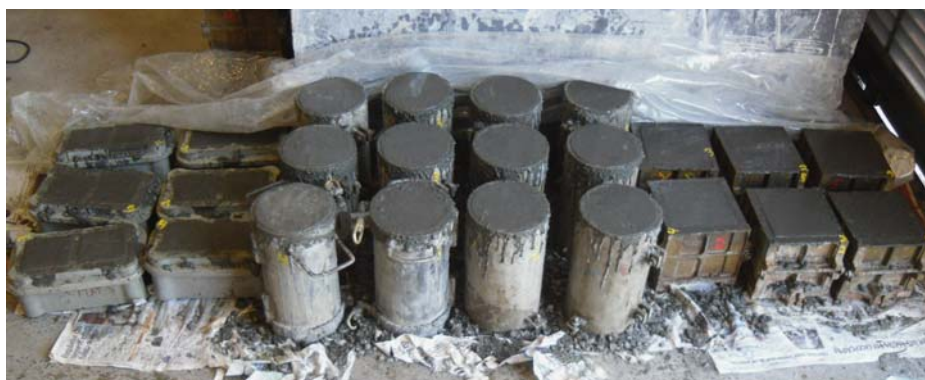
Figura 7 – Moldes dos provetes de caracterização do betão.
