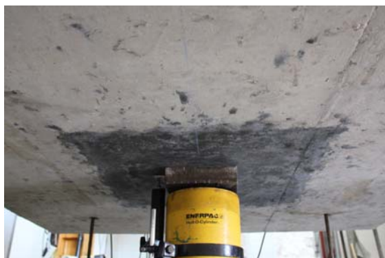
Figura 10 – Vista inferior do modelo SHSC7 sobre o macaco hidráulico.
