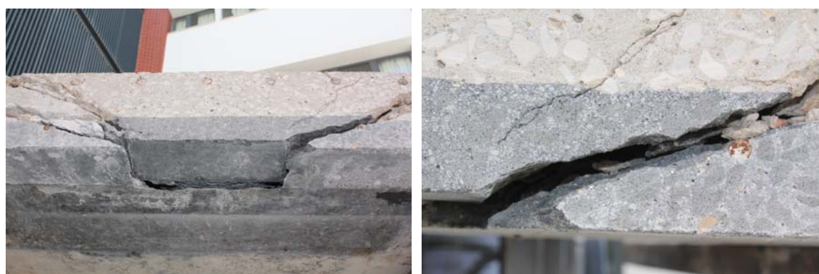
Figura Erro! Não existe nenhum texto com o estilo especificado no documento. 24 – Vista pormenorizada da superfície de rotura do modelo SHSC8.
