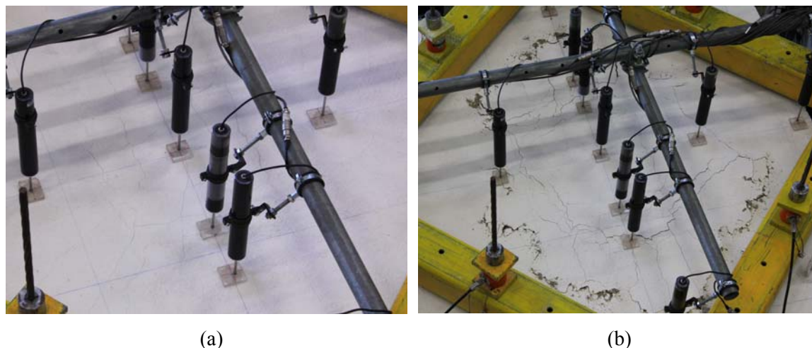
Figura 23 – Modelo SHSC8: (a) vista superior imediatamente antes da rotura; (b) vista superior após a rotura.
