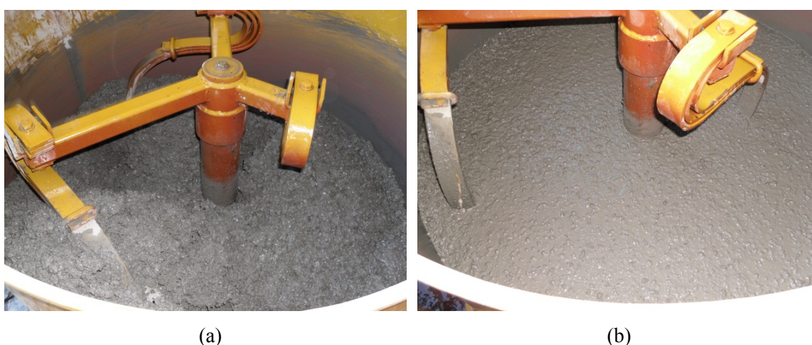
Figura 11 – Após introdução do superplastificante (a) e aspeto final do betão (b).
