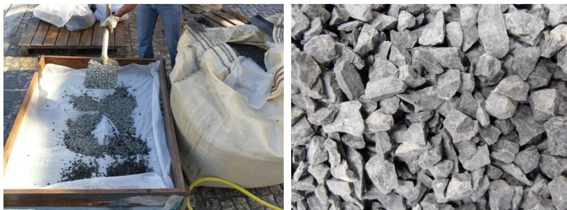
Figura 14 – Equipamento utilizado na lavagem dos agregados grossos (a) e agregados de basalto depois de lavados e secos (b).
