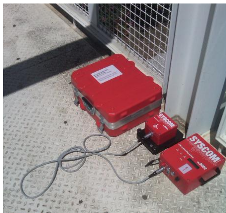
Figura 4.1: Sensor de velocidades MS2003 ao centro e gravador de vibrações MR2002 à direita
