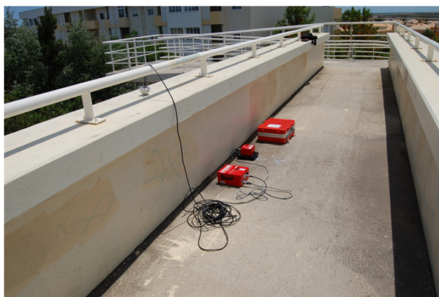
Figura 5.20: Posicionamento dos instrumentos de medição no PP3141.
