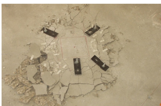
Figura 5-6 – Modos de rotura para os modelos ID5, a) ID5, b) ID5 RCM, c) ID5 RCM Refinado, d) Experimental [17]
