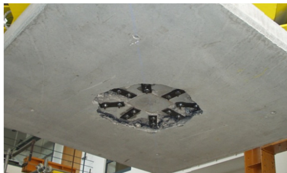
Figura 5-3 – Modos de rotura para os modelos ID2, a) ID2, b) ID2 RCM, c) ID2 RCM Refinado, d) Experimental [17]
