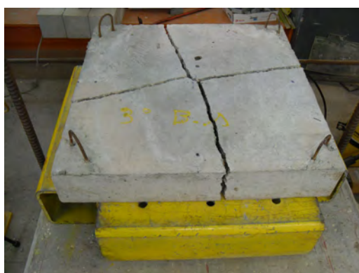
(a) Rotura de um painel de laje quadrado sem fibras.
