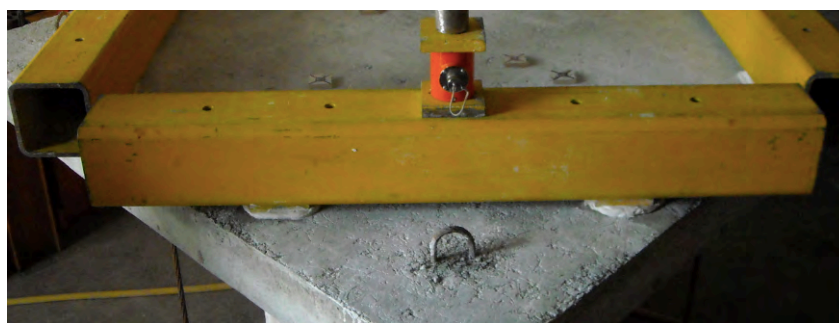
Figura 3.5: Perfil metálico RHS apoiado nas placas de aço com gesso.
