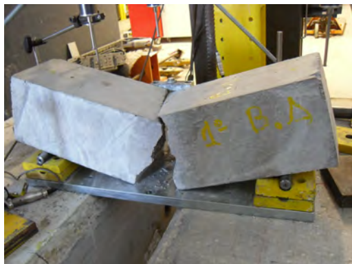
(a) Rotura de uma viga entalhada sem fibras.
