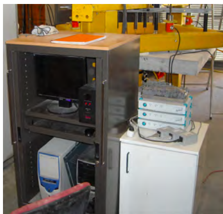
(b) Ligação dos Data Logger HBM Spider 8 ao computador.
