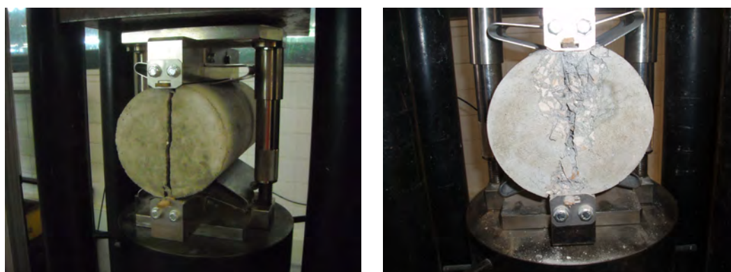
(a) Rotura de provete cilíndrico sem fibras.
