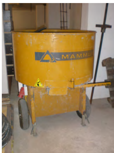
(a) Betoneira modelo Mammut.
