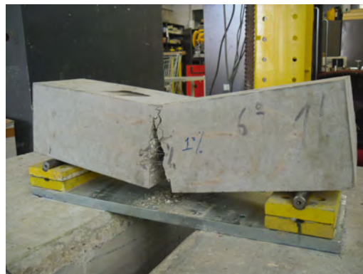
(b) Rotura de uma viga entalhada com fibras.
