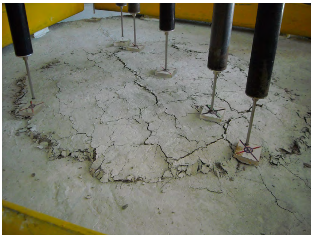
Figura 3.37: Vista geral da rotura por punção do modelo ND5.
