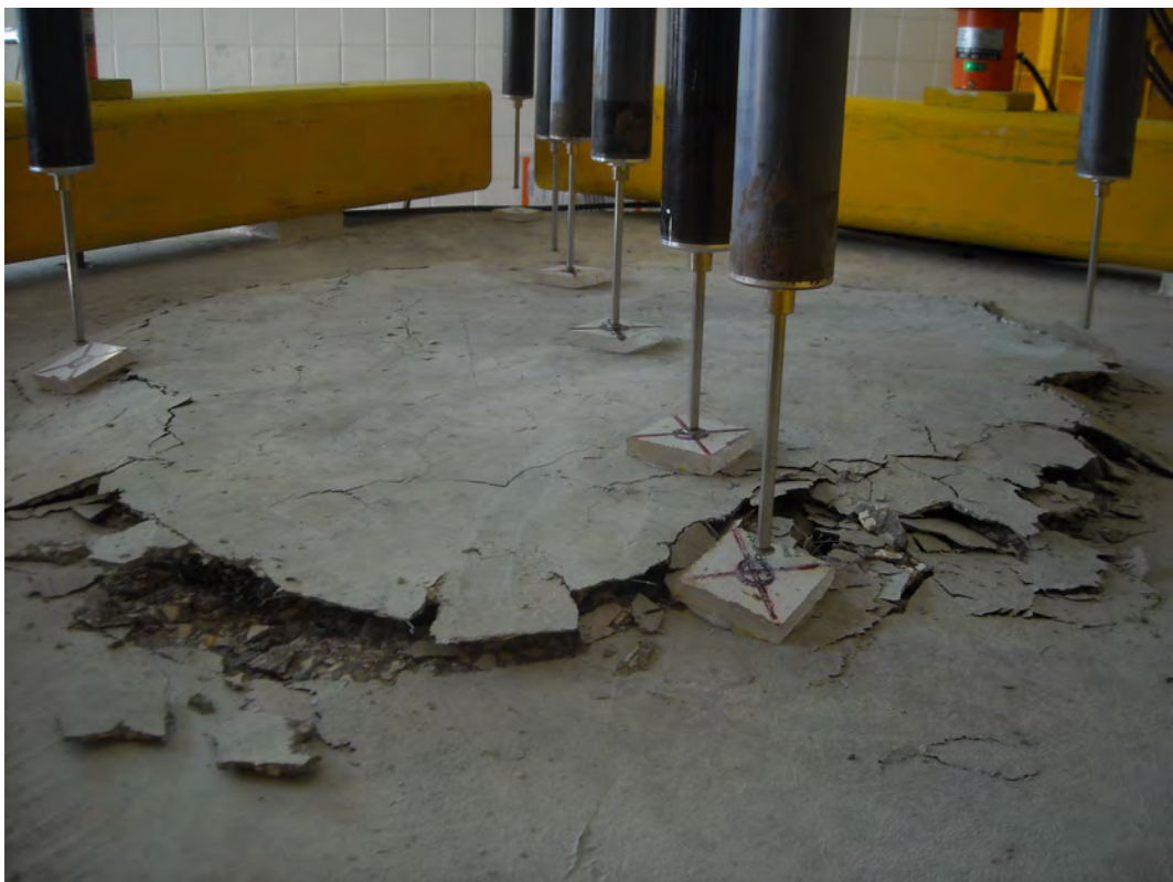
Figura 3.33: Vista geral da rotura por punção do modelo ND1.
