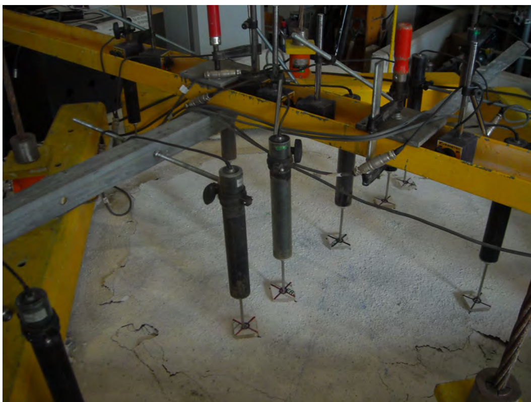
Figura 3.32: Vista geral da rotura por punçoamento do modelo ND0.
