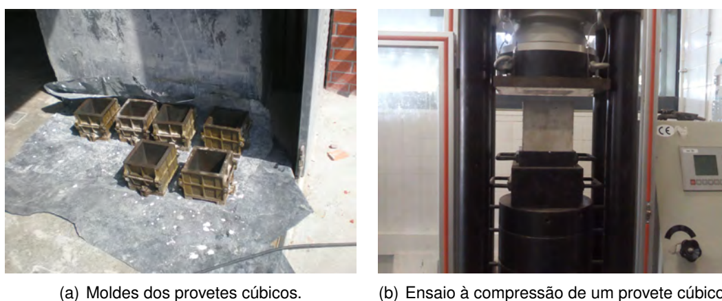
Figura 3.14: Moldes e ensaio de provetes cúbicos [16].
