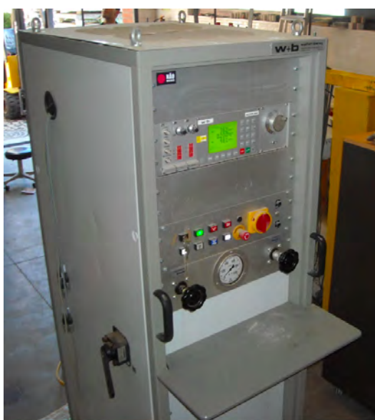
Figura 3.6: Aspecto geral do grupo hidráulico WALTER BAI AG tipo NSPA 700 / DIG 2000.
