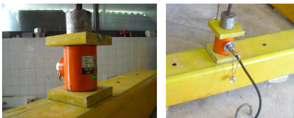
Figura 3.25: Célula de carga TML do tipo CLC-200KNA.
