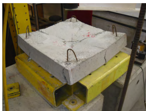
(b) Rotura de um painel de laje quadrado com fibras.
