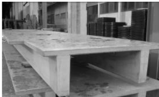
Figura 5. 11 - Viga em “ \pi ”, pré-fabricada com 15 m de comprimento e 3 m de largura para aplicação em pontes pedonais, Monai e Schnabl, 2008
