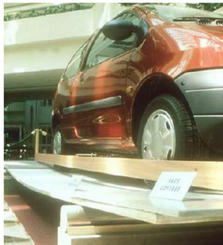
Figura 5. 8 - Laje (1,8 m x 3 m), constituída por UHPC de 25 mm de espessura suportando um automóvel, Harris, 2010
