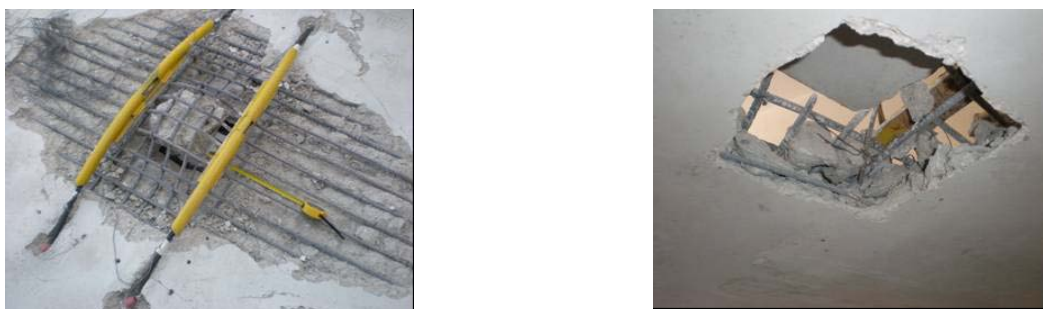
Fig. 17 Aspecto de um modelo após atingir carga máxima de pós-rotura por punçoamento
