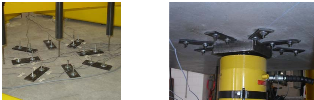
Fig. 4 Reforço por introdução de armaduras transversais, Inácio Duarte [12]
