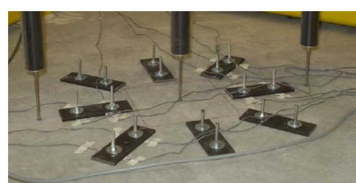
Fig.5 – Aspecto geral do reforço de um dos modelos antes da aplicação da resina – Vista Superior e Inferior.
