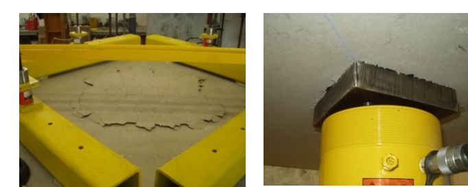
Fig.12 – Vista superior e inferior do modelo de Referência (R) após rotura
