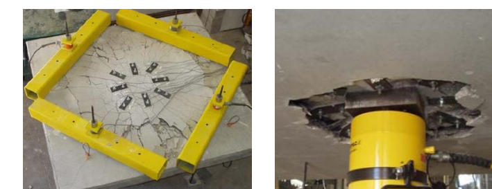
Fig.14 – Vista superior e inferior do modelos M8 após rotura
