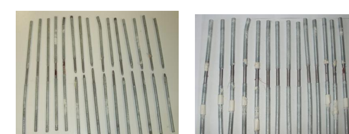
Fig.17 – Pormenor dos parafusos depois de rotura por punção nos Modelos M6 a M8
