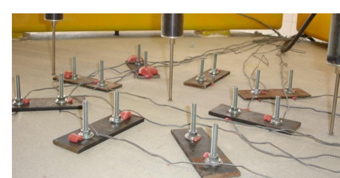
Fig.6 – Aspecto geral do reforço de um dos modelos durante a aplicação da resina – Vista Superior e Inferior.
