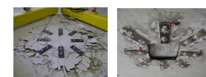
Fig.16 – Vista superior e inferior do modelo M8b após rotura
