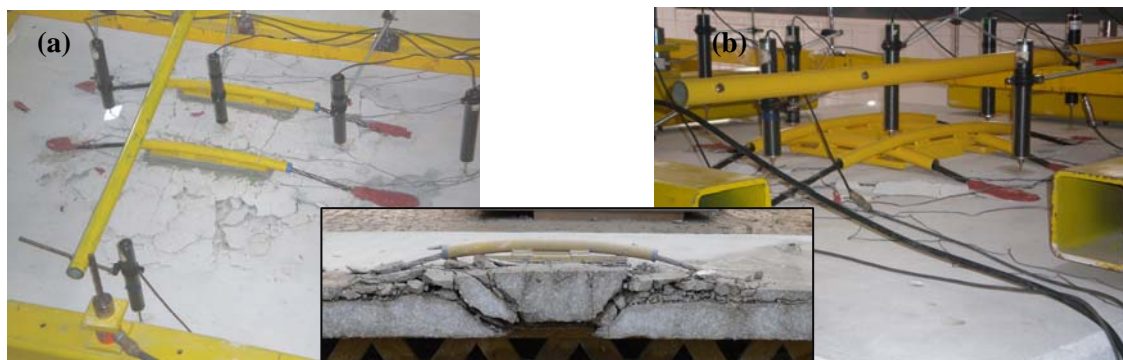
Figura 5. Rotura dos modelos (a) DF6 e (b) DF7.
