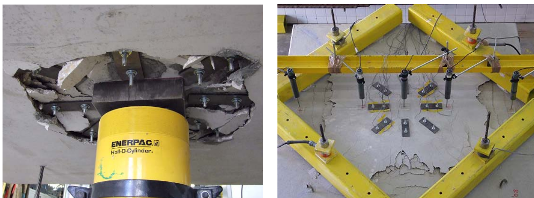
Figura 10. Vista inferior e superior do modelo ML2 após a rotura
