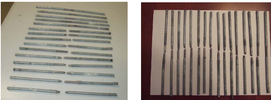
Figura 9. Parafusos dos modelos ID3 e ML1 após a rotura
