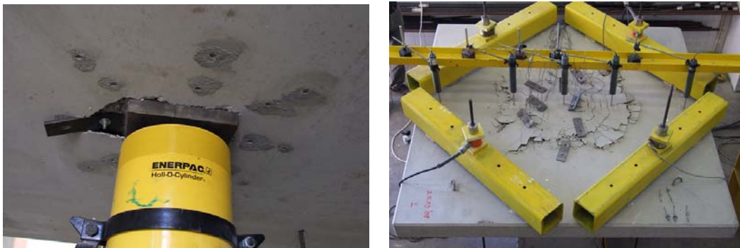
Figura 8. Vista inferior e superior do modelo ML1 após a rotura
