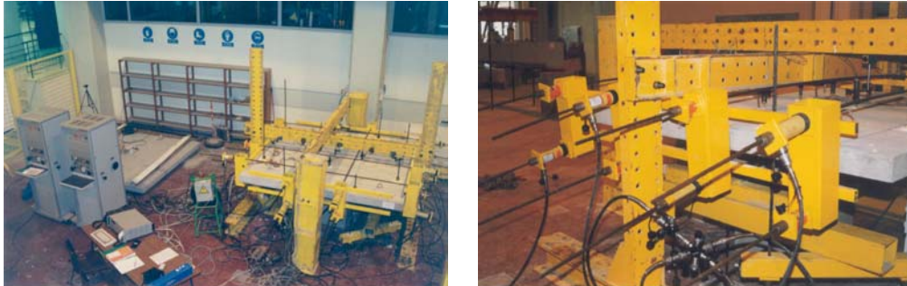
Figura 2 – Aspecto geral de um ensaio e do sistema de aplicação da compressão
