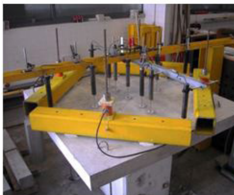
Figura 4: a) foto de um modelo de laje a ser ensaiado e b) esquema em corte da geometria do ensaio.
